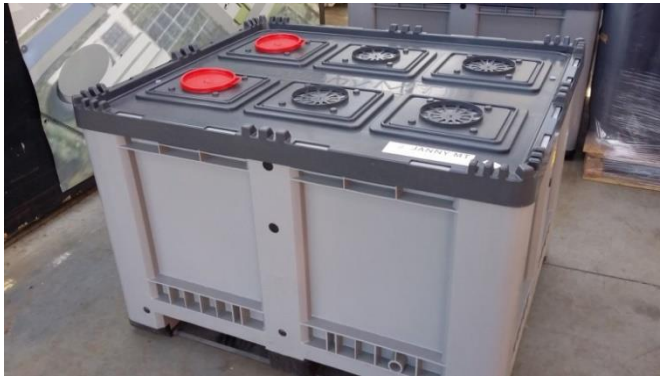
Figuur 1: Janny MT cubitainer met 6 membranen in het deksel die door middel van een rood deksel afgesloten kunnen worden.
